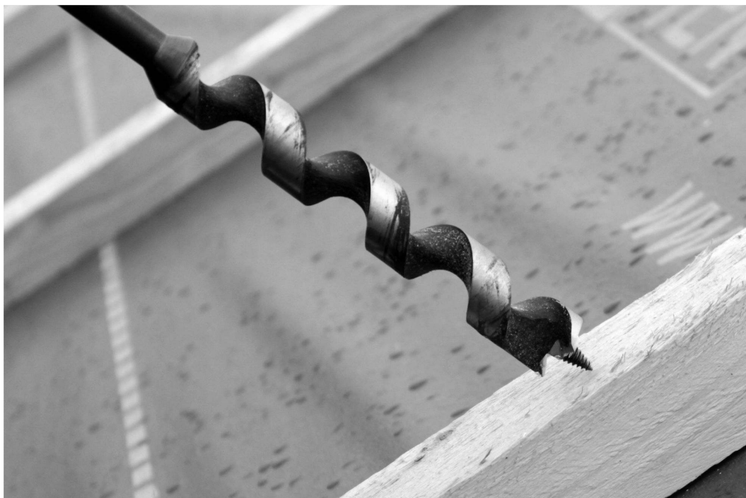
Obr 16. - Spirálový vrták pro zahloubení dosedací plochy pro hlavu vrtu
