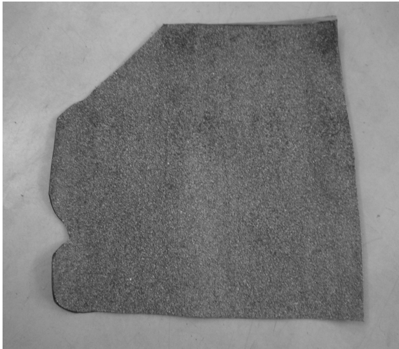
Obrázek /22/ Speciální tvar asfaltového pásu s posypem přivedeného po atice k detailu vnějšímu rohu
