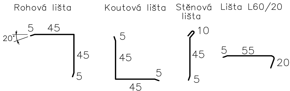
Schéma 2. Příklady tvarů nejčastěji používaných profilů. Aplikace jednotlivých profilů je patrná z následujícího textu.
