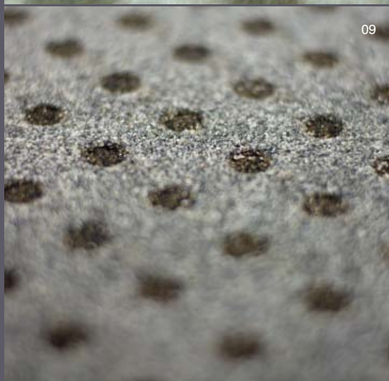
08, 09 | Vliv použití geotextilie na otláčení asfaltového pásu na tuhém podkladu
