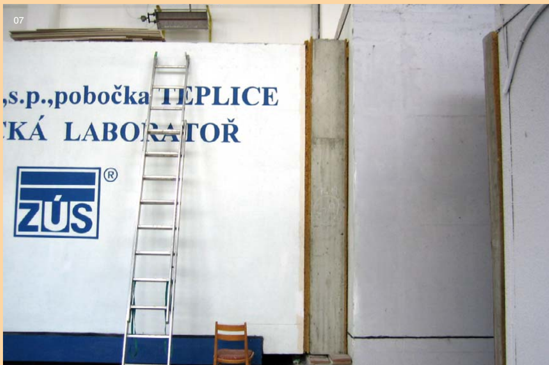
07 | ŽB rám se zkušební vzorkem Dekpanelu D vsazený mezi měřicími místnostmi
